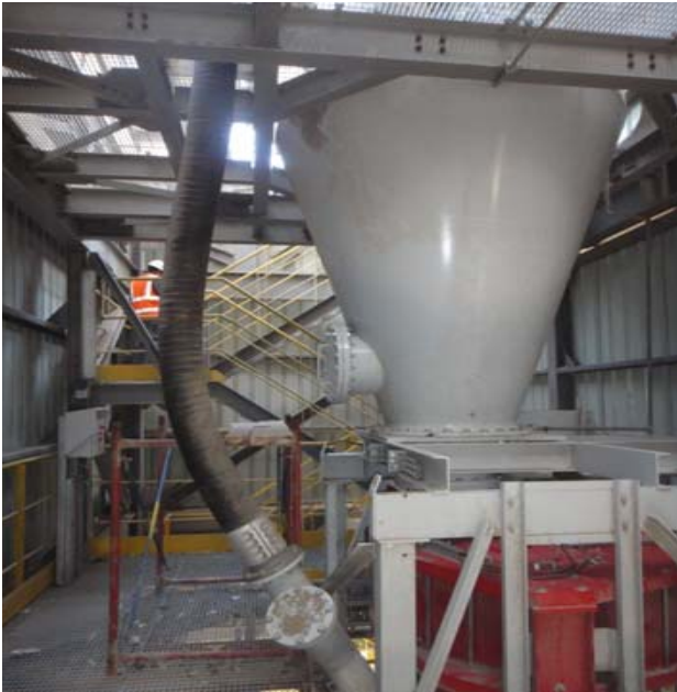
الصورة 5: عادل عزت ، مدير الوقود البديل لدى الشركة العربية للإسمنت يقدم جهاز التغذية الدوار Pfister® TRW-S/D لتغذية الوقود البديل في مصنع إسمنت الرملية في مصر
