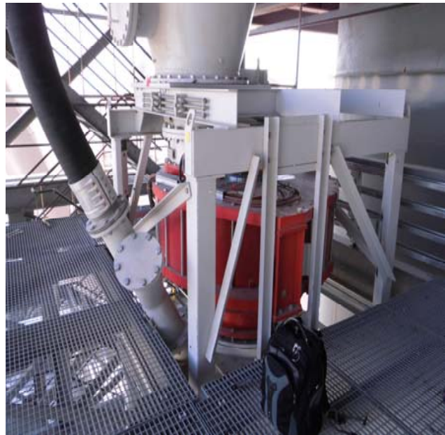
الصورة 5: عادل عزت ، مدير الوقود البديل لدى الشركة العربية للإسمنت يقدم جهاز التغذية الدوار Pfister® TRW-S/D لتغذية الوقود البديل في مصنع إسمنت الرملية في مصر
